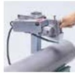
①パイプ口径モーター高さ設定メモリを合わせ、刃物と切断位置を合わせて下さい。(本体ローラーの目安線に合わせても結構です。)
