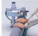
③切り込みが終わったら、続けてパイプを必ず手前に廻して切断して下さい。
