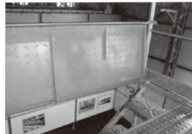
足場板を 開いた状態
