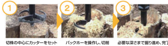
切株の中心にカッターをセット バックホーを操作し、切削 必要な深さまで掘り進め、完了
